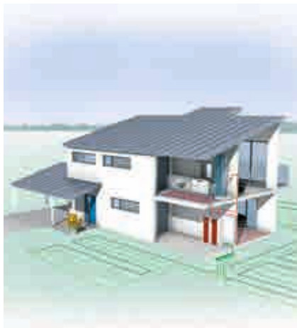
Pompe à chaleur sol/eau avec des collecteurs horizontaux
