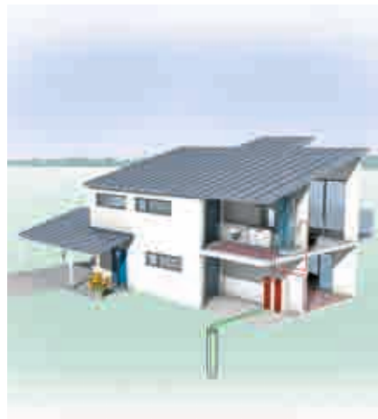
Pompe à chaleur sol/eau avec forage vertical
